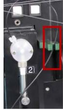
9. 注意 3 个黑色的插销要保存好，用完自动进样器后要插回原位，以防止外界的光进入检测系统。
