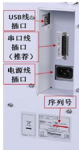
Varioskan Flash 和计算机相连的数据线可以选择 USB 线或串口线，推荐使用串口线连接计算机，因为串口线数据传输速度快且稳定，计算机要求配有 9 针串口，如果没有 9 针串口，则使用 USB 线连接计算机。
